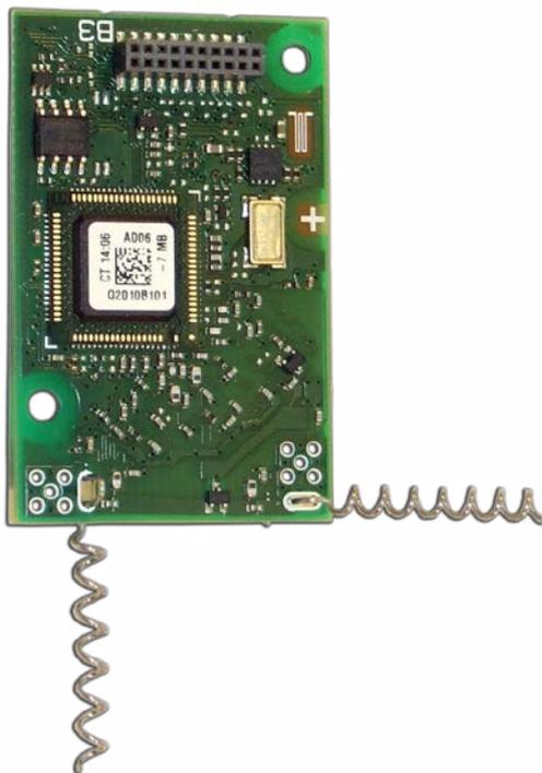
Das Gigaset MD40 bietet beste Leistung in einem kleinen Modul für Vollduplex-Datenfunk via DECT Standard.
