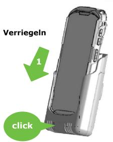
Gerät bis zum Anschlag ins Cradle einlegen (1) und mit leichtem Druck in Pfeilrichtung einrasten lassen.
