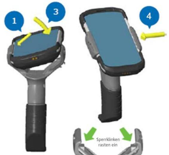
Wenn das TC7x Scan Handle richtig montiert wurde, ertönt ein leises "klick", sobald der Scan Button betätigt wird.
