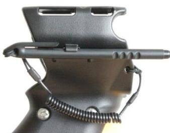
Für einfachen Zugriff auf den TC7x-Stift bietet der Scan-Griff eine Halterung für den Stift und ein Loch zur Befestigung des Stiftkabels. Das Bild zeigt den Scan Handle mit montiertem Stift.
