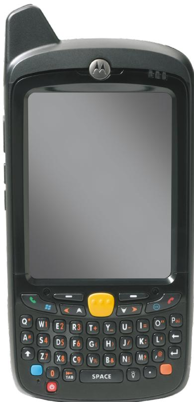
Der robuste EDA bietet alle aktuellen Verbindungsstandards in einem Gerät: UMTS/HSPA, GPRS/EDGE, WLAN, Bluetooth® und GPS. Damit sind nicht nur Sprach- und Datenkommunikation, sondern auch Navigationslösungen über ein einziges Gerät möglich. Der Einsatz unterschiedlicher Endgeräte ist damit überflüssig.
