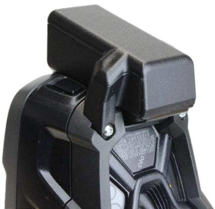
Snap-on Adapter montiert.
