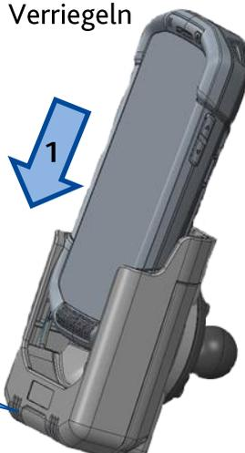
Gerät ins Cradle einlegen (1) und mit leichtem Druck in Pfeilrichtung einrasten lassen.
